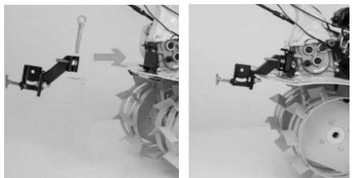
1. Se montează adaptorul de accesoriu și se fixează cu bolț.
