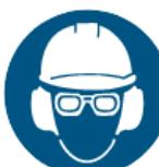
Operatorul trebuie să poarte Echipament Personal de Protecție (PPE). Dacă mașina este în uz, trebuie să purtați ochelari de protecție împotriva obiectelor proiectate în aer, trebuie purtate elemente de protecție a auzului cum ar fi casca izolată acustic.
