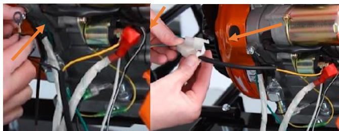
Pe bobină se couplează element de legatură far, cuplând masa pe borna negativă.
